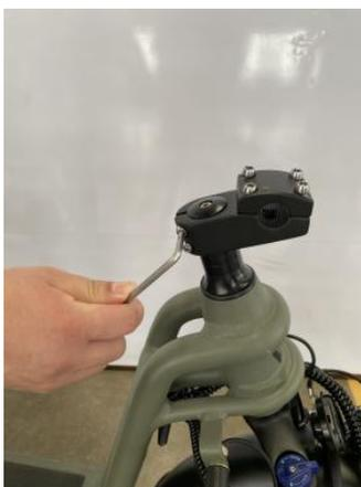
**6a etapa :** Posicione a base do guidador de forma que a passagem do guidador fique voltada para a frente do seu WiMob e reaperte os dois parafusos de fixação da base. Em
