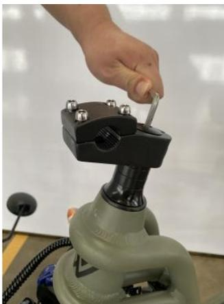
**5a etapa :** Desaperte o parafuso de fixação do eixo do guidador.
