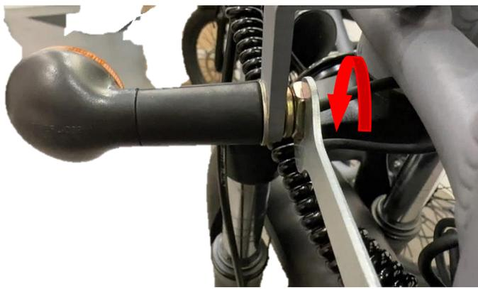
**13ª etapa** : Instale o conjunto do farol traseiro na parte traseira do quadro, aperte as duas porcas usando a chave fornecida e conecte a ficha da viga.
