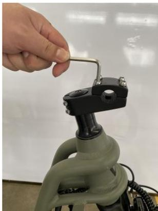
**7ª etapa :** Desparafuse os quatro parafusos que prendem a base do guidador e remova a metade superior da base
