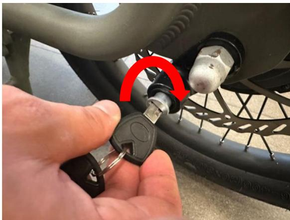
Para remover bloqueio do disco, basta girar a chave do bloqueio do disco no sentido horário. A fechadura estará assim destravada e retornará à posição inicial.
