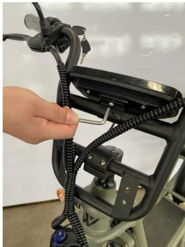
**11° etapa :** Por fim, posicione a tampa frontal do seu ciclomóvel na frente do guidão. Aparafuse-o utilizando os quatro parafusos auto-roscantes M5x16 fornecidos.
