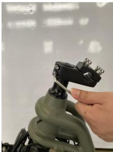
**4a etapa :** Desaparafuse os dois parafusos de fixação da base do guidador.
